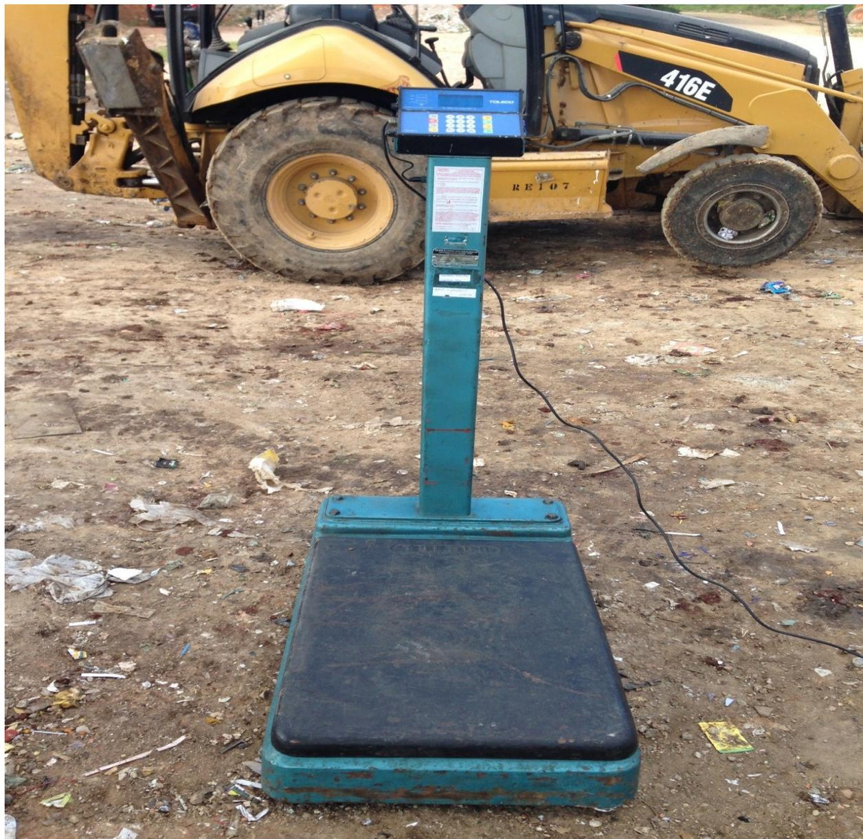
Figura 34 Balança eletrônica de solo, gravimetria 2014.
