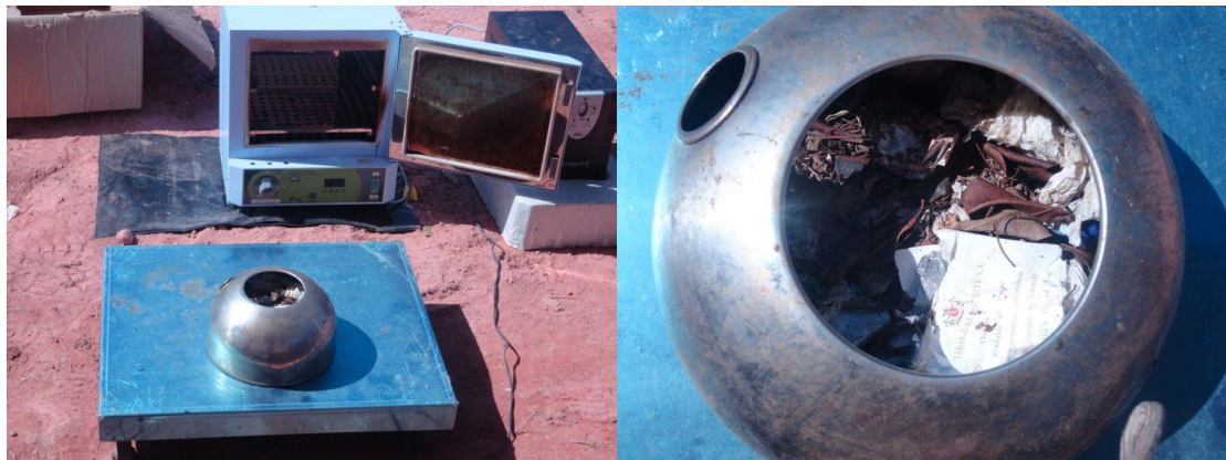
Figura 14 - Retirada do recipiente de 2 L da estufa e pesagem para determinação do teor de umidade.
