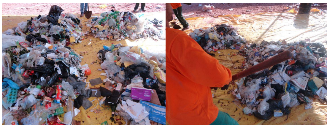
Figura 8 - Quarteamento e seleção de amostragem homogeneizada.
