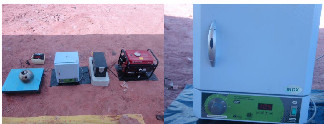
Figura 10 - Amostra de 2L de resíduos sendo pesada e posteriormente inserida em estufa que aquecerá até 105°C.
