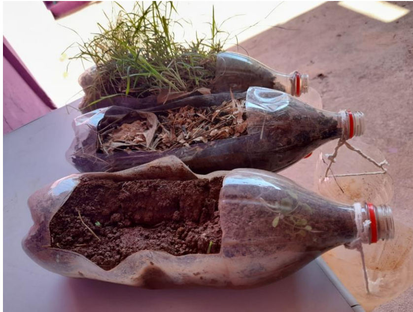
Imagem 03 – Ilustra o protótipo de Erosão Hídrica.
