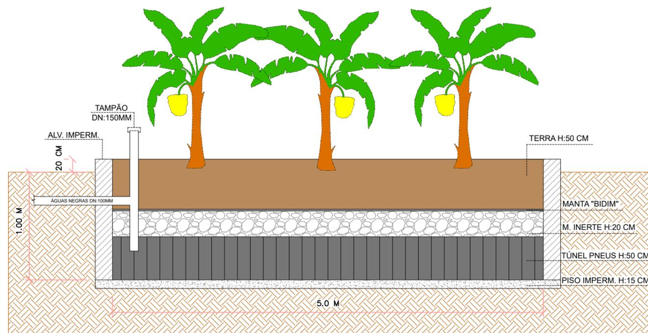
DETALHE LONGITUDINAL - TANQUE DE EVAPOTRANSPIRAÇÃO
