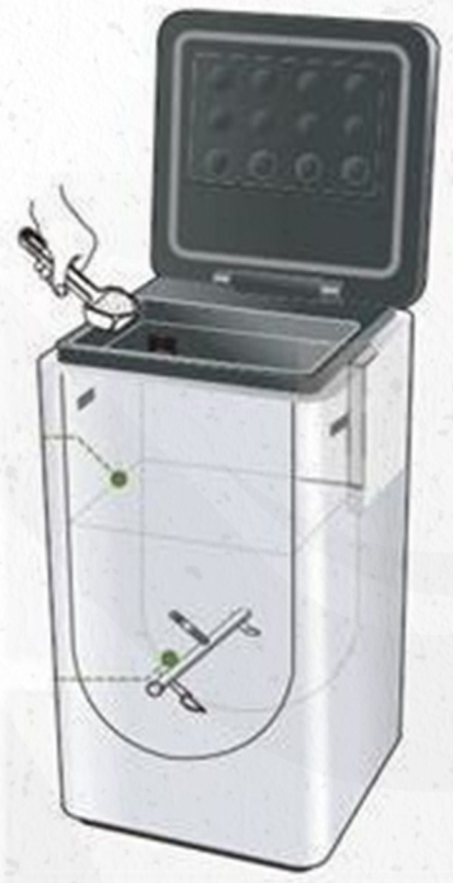
Figura 18 - Esquema de uma Composteira Elétrica Fonte: Researchgate.
