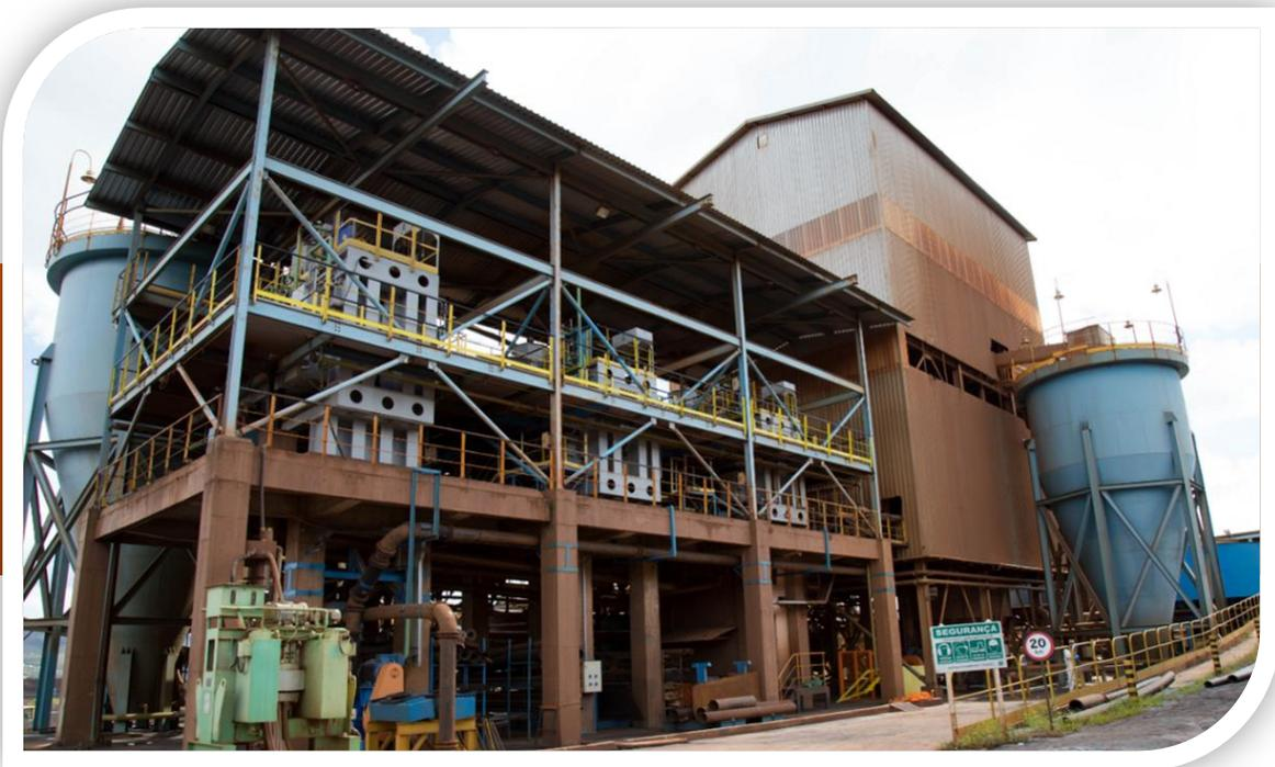
Concentradores Magnéticos e Prédio de Espirais que compõe a concentração de sinter feed. A direita observa-se o espessor de coluna EP-01.
