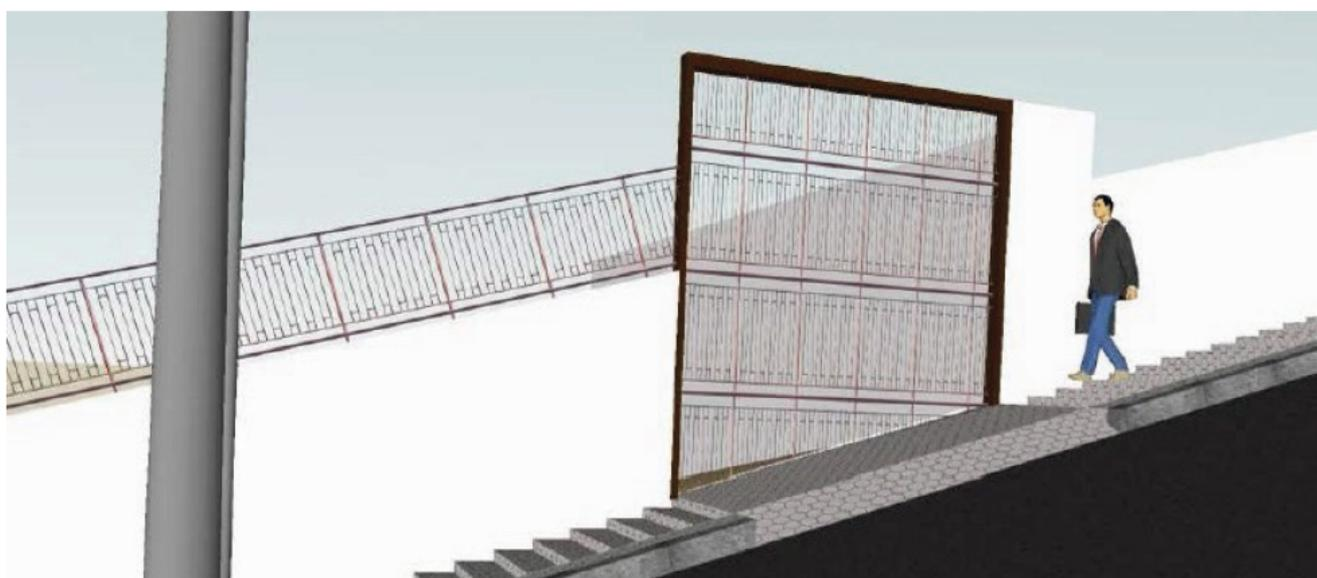
**Figura 5 - Calçada com inclinação longitudinal maior que 25%: entrada**
