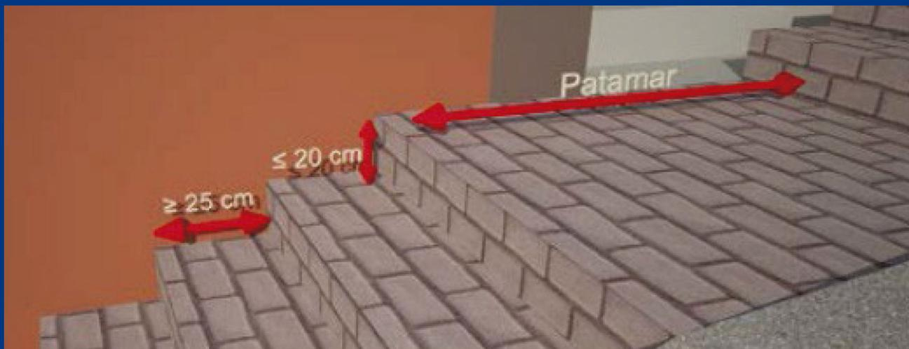
Figura 6 - Medidas para construção de degraus em calçadas com inclinação maior que 25%.
