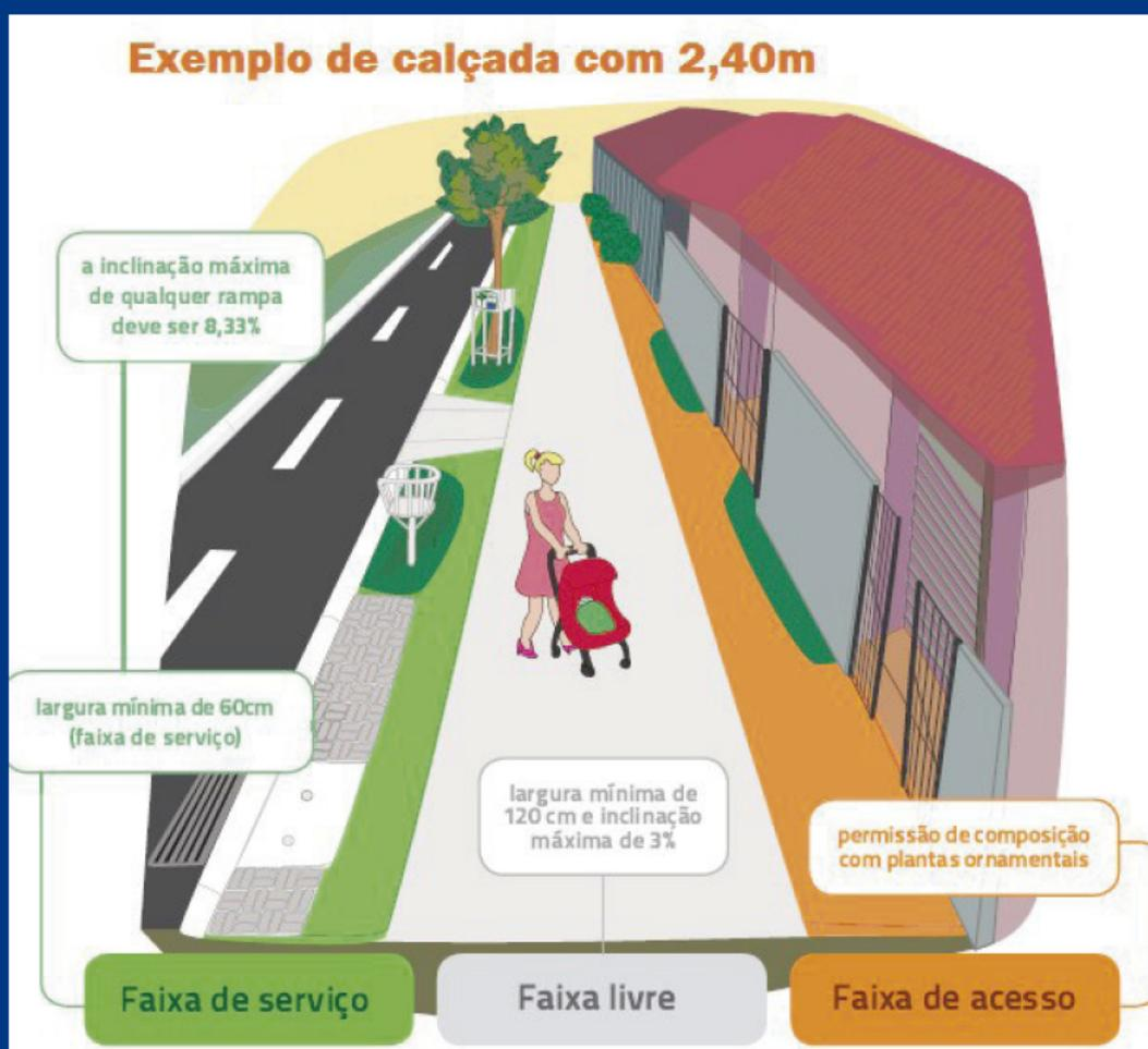
Figura 2 - Medidas mínimas para uma calçada de 2,40 metros.
