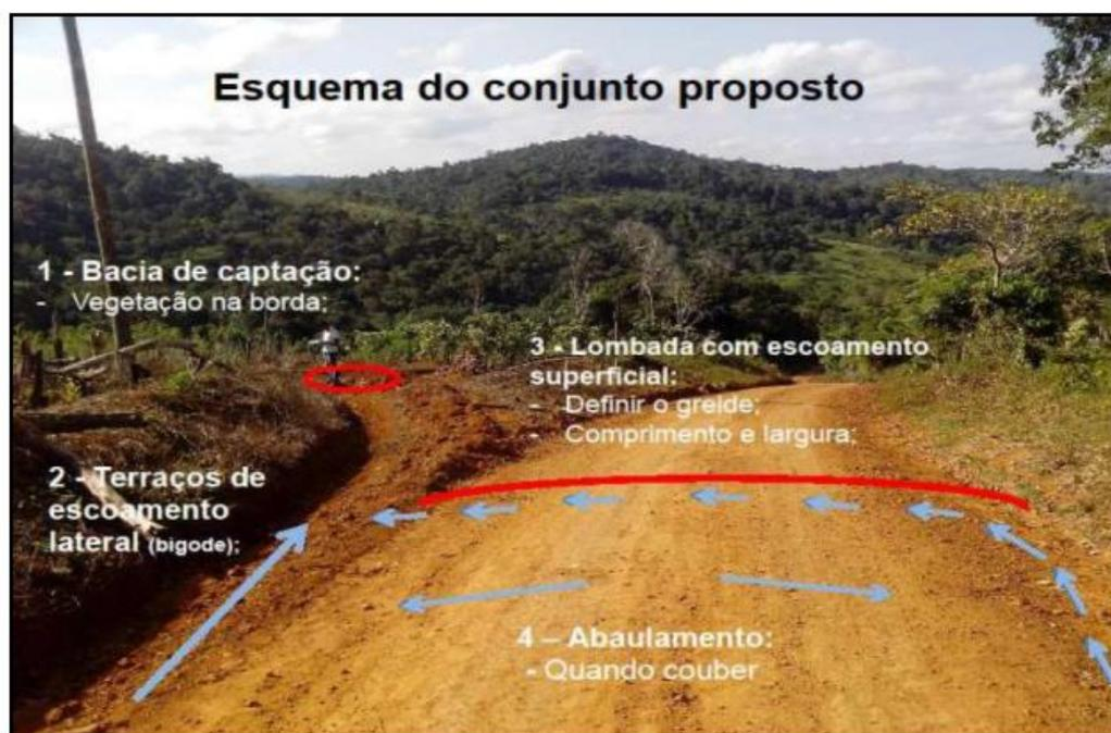
Figura 4. Imagem esquemática de drenagem de estradas. Fonte \*1
