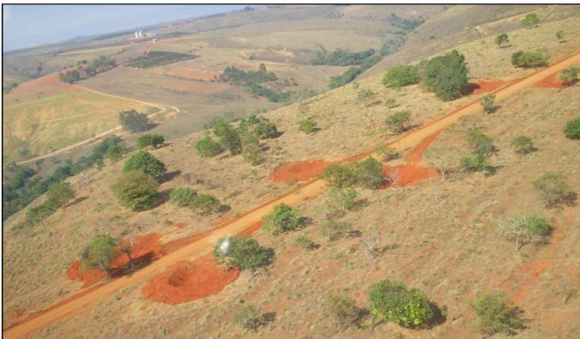
Figura 5. Vista aérea das bacias de contenção ao longo da rampa da enconsta (Fonte \*2)
