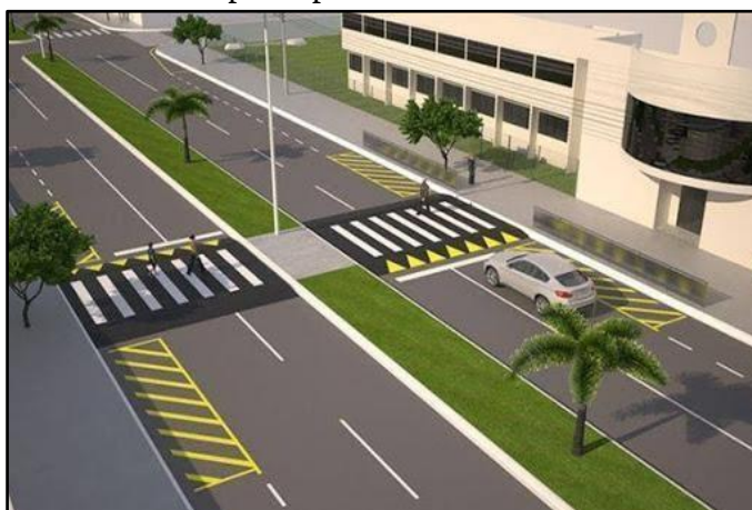
FIGURA 65 - Travessia composta por lombofaixas.
