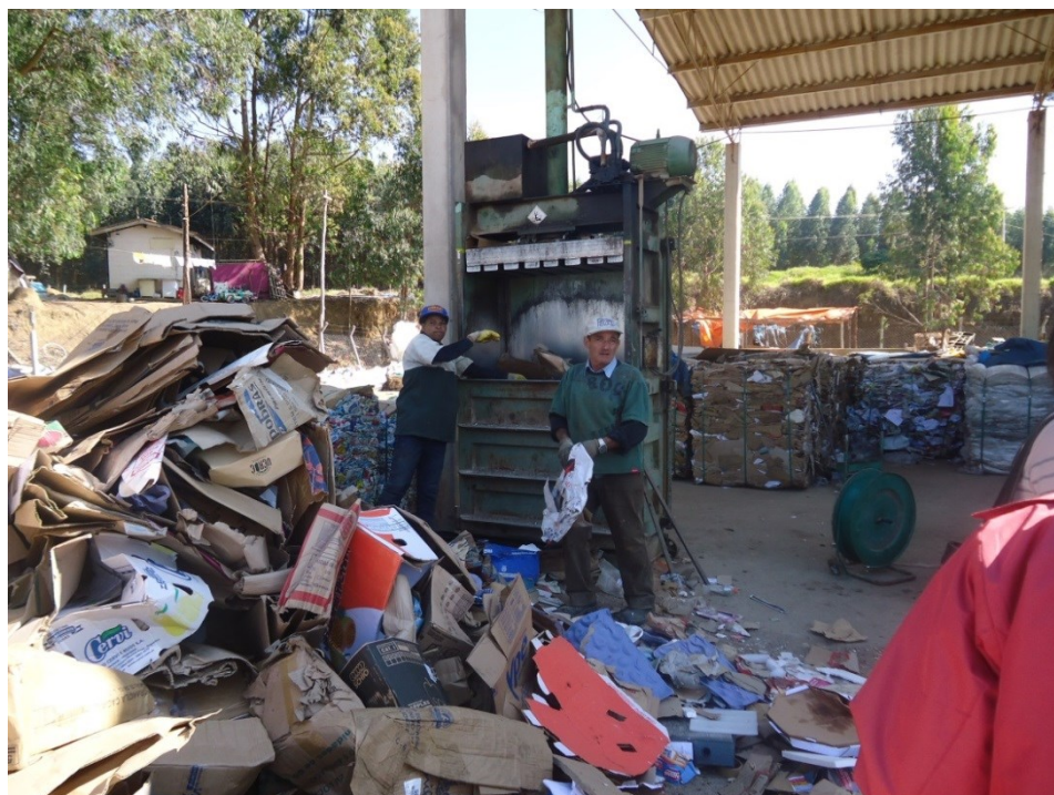
Figura 35 - Detalhe da prensa utilizada pela CRI.
