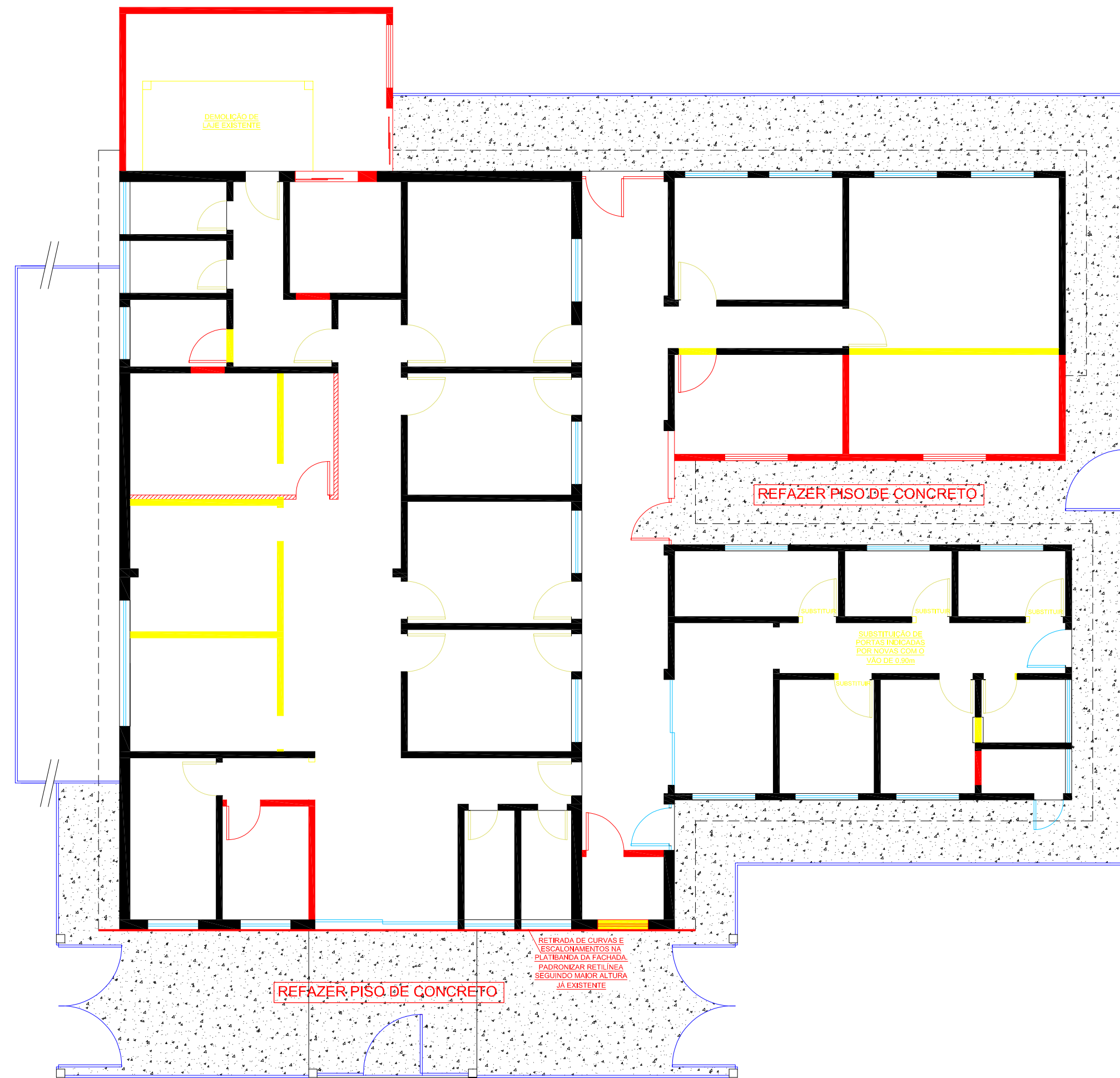
Planta Baixa - Construir/Demolir Esc. 1:100
