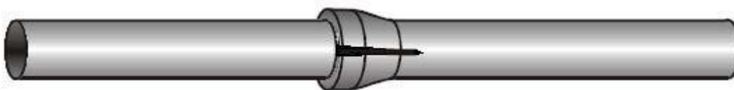
Figura 103 – Fissura na bolsa
