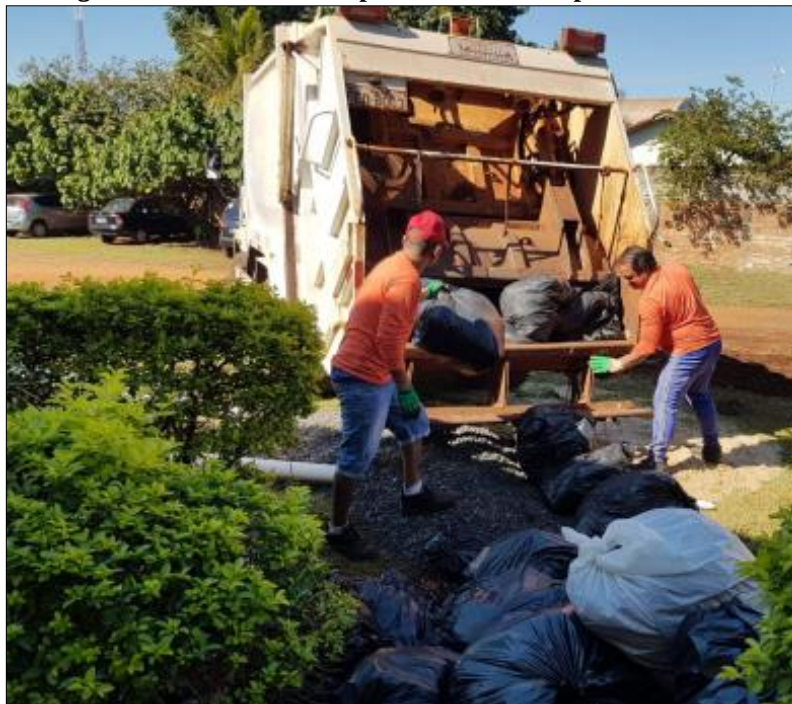
Figura 50 - Caminhão compactador utilizado pela Prefeitura.
