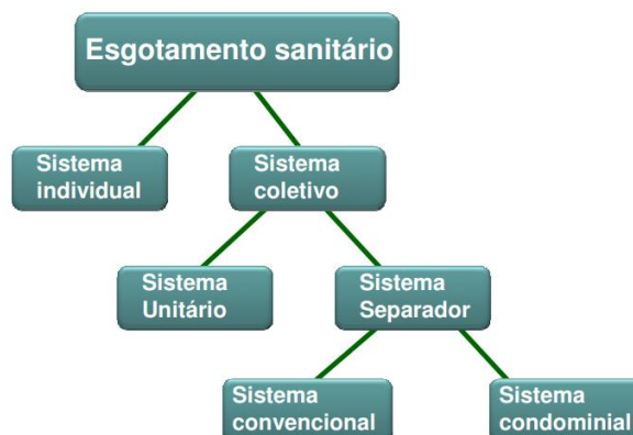
Figura 76 - Tipos de Sistema de Esgotamento Sanitário.
