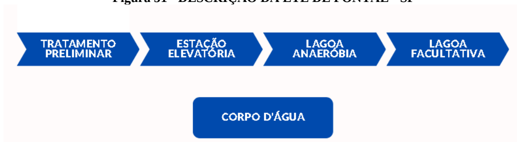
Figura 51 - DESCRIÇÃO DA ETE DE PONTAL - SP
