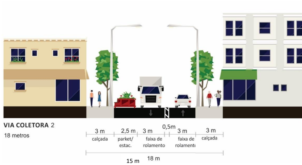
Figura 3 - Perfil da Via Coletora 2
