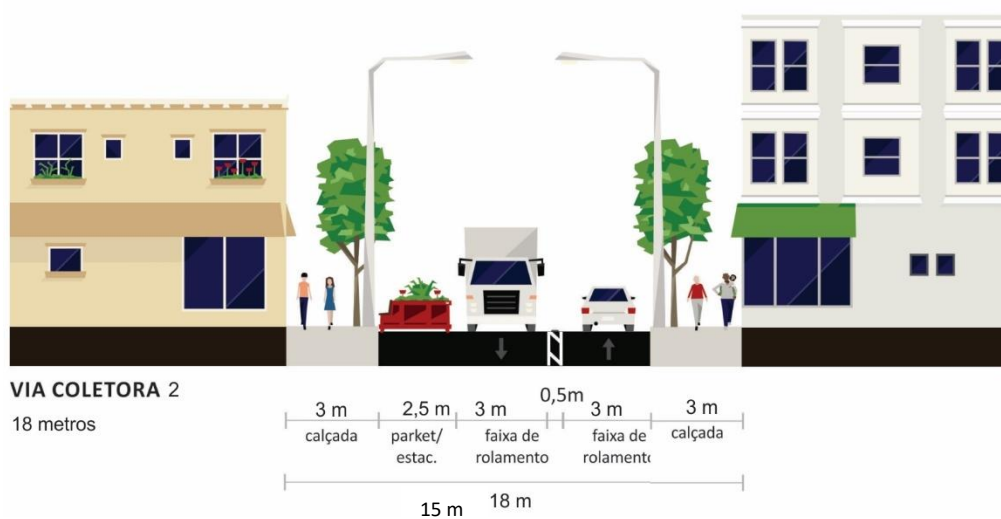
Figura 3 - Perfil da Via Coletora 2
