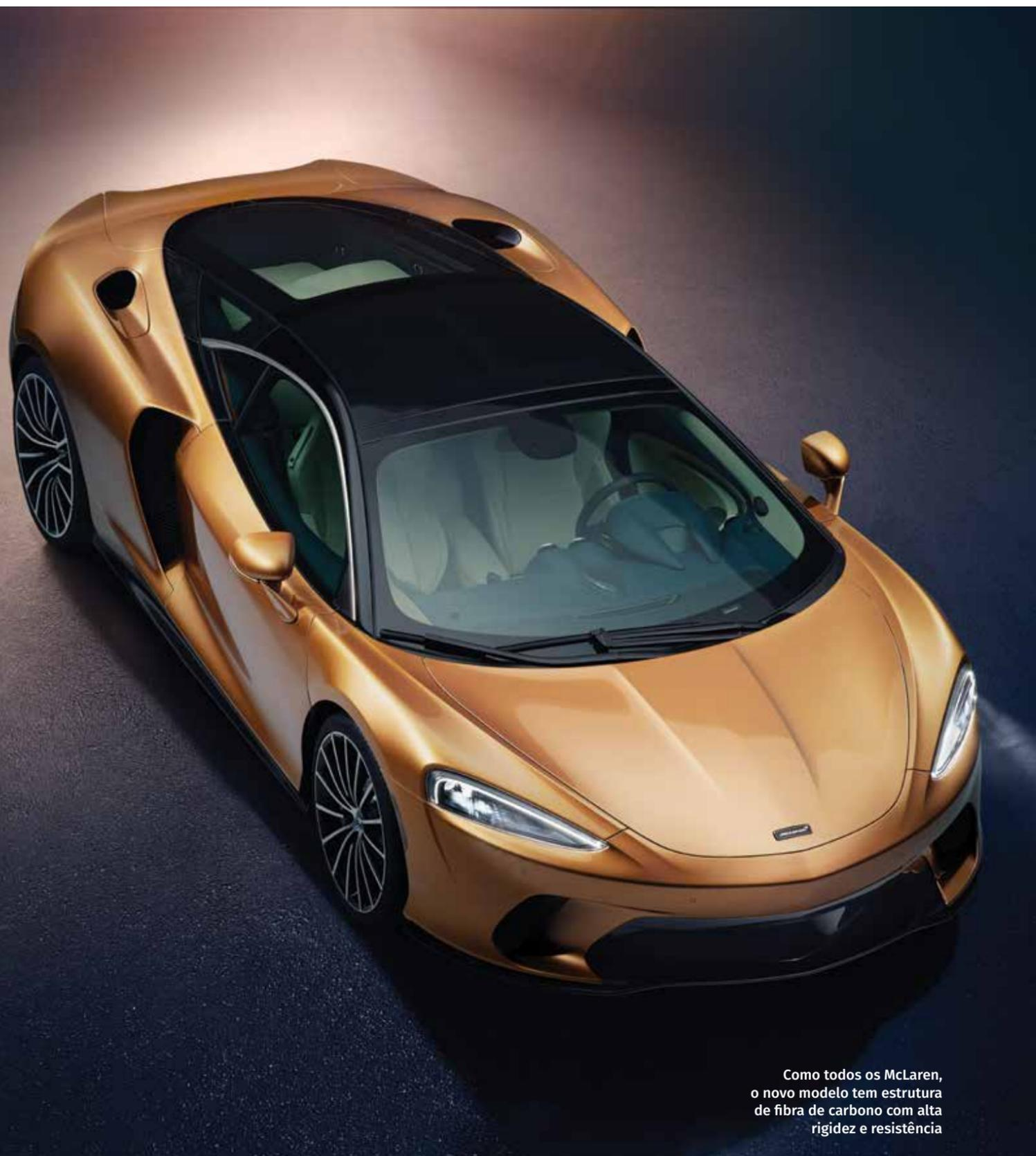
Como todos os McLaren, o novo modelo tem estrutura de fibra de carbono com alta rigidez e resistência
