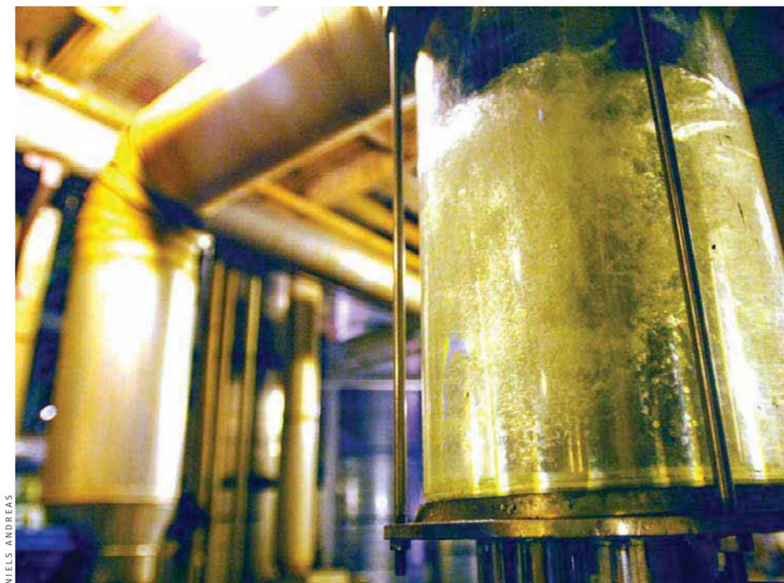
Equipamento utilizado na destilação do etanol, que pode reduzir em 90% a emissão dos gases de efeito estufa
