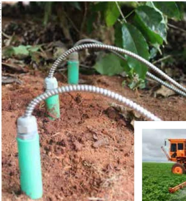
Sensores de solo controlam a umidade e os tratores inteligentes pulverizam apenas os locais específicos com a quantidade certa de defensivos
