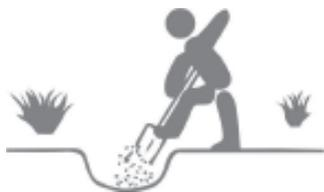
4 – Misture bem a fatia cortada ainda dentro da cova e retire um punhado da mistura. Coloque a quantidade retirada – AMOSTRA SIMPLES – no balde ou saco plástico.
