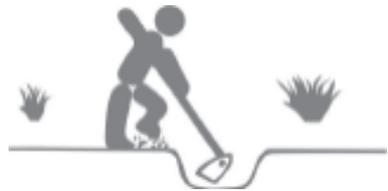
3 - Acerte uma das paredes da cova, deixando-a bem a prumo. Faça esse acerto com cavadeira reta, retirando o pondo de lado a terra que caiu dentro da cova. Da parede que ficou a prumo, corte uma fatia uniforme de
