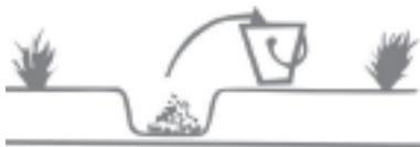
**OBSERVAÇÃO:** As amostras de solo podem ser retiradas com maior precisão e menor trabalho usando-se um trado. Procure conhecer, com o técnico da EMATER, esse instrumento e informar-se como utilizá-lo para retirar amostras de terra.
