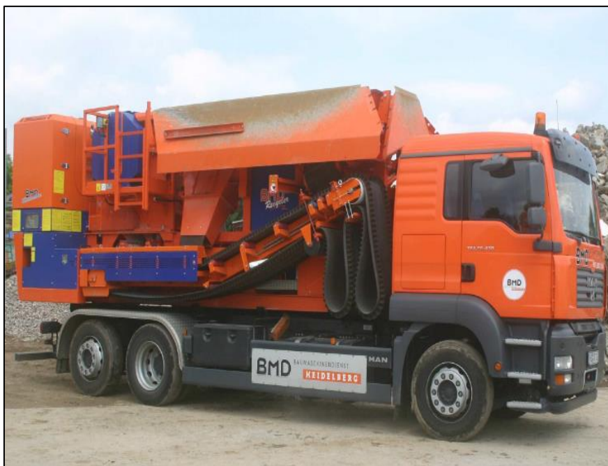
Figura 5 - Usina móvel de reciclagem de RCC.
