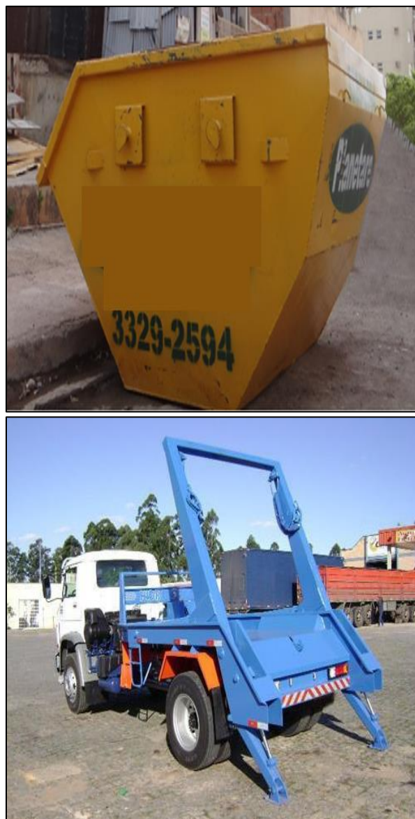
Figura 7 - Modelo de caçamba para acondicionamento de resíduos da construção civil e caminhão poliguindaste para o recolhimento da caçamba.
