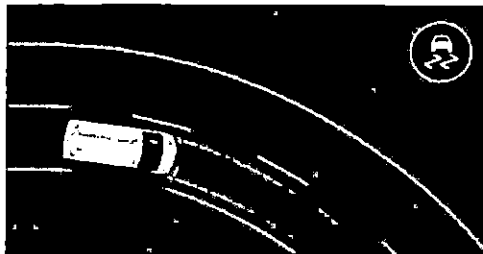
controle de estabilidade (ESP) e controle adaptativo de carga (LAC) O ESP corrige a trajetória do carro para evitar derrapagens. O controle adaptativo de carga identifica o deslocamento do eixo e o centro de gravidade do veículo para otimizar a eficiência da frenagem, a tração e a estabilidade.
