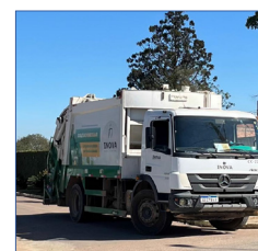
Figura 18: Caminhão Coletor Compactador Utilizado para a Coleta Regular de Resíduos Sólidos Domiciliares e Públicos
