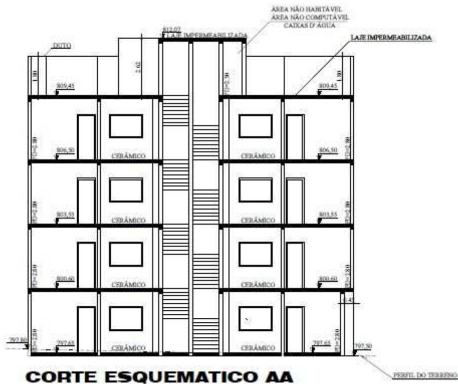
Imagem 28-A - Corte Esquemático AA
