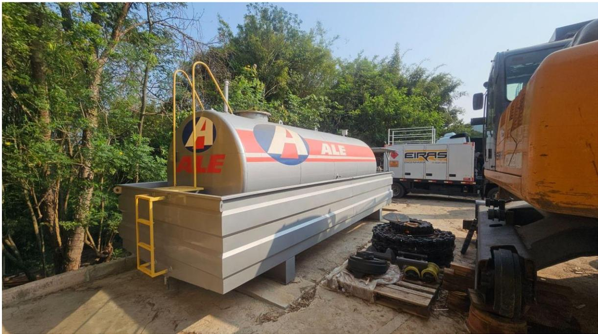
Foto 12: Tanque de abastecimento de Diesel para os veículos pesados (abaixo de 15 m<sup>3</sup> - dispensado de licenciamento).
