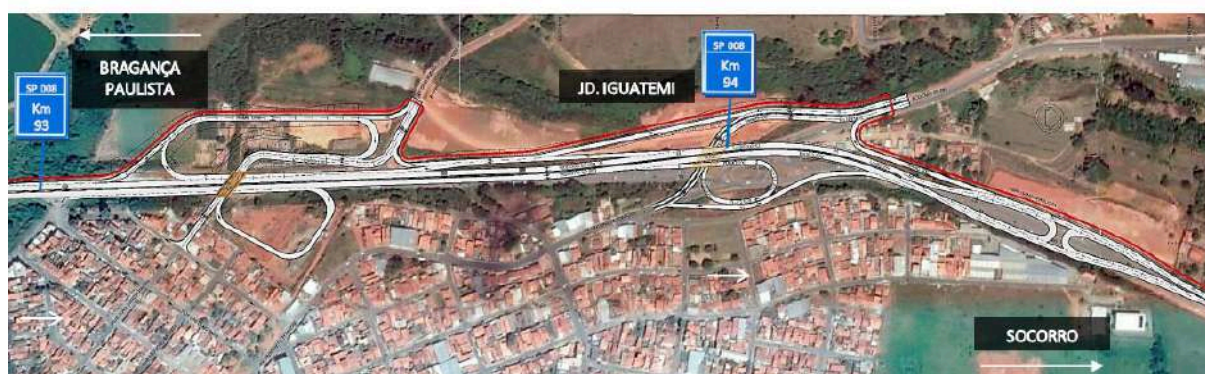
Figura 23 – Projeto Geométrico do trevo na interseção da Rod. Cap. Bardoíno x Av. Dom Bosco (à esquerda) e o trevo na interseção da Rod. Cap. Bardoíno x Rod. Benevenuto Moretto (à direita).
