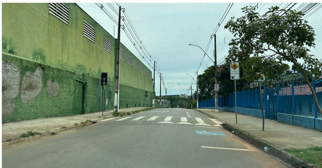
Imagem 37 Faixa elevada na Avenida Nossa Senhora da Penha. Data 03/02/2024.
