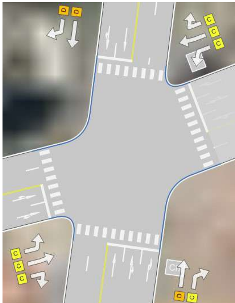
Figura 21 – Simulação atual com e sem o empreendimento (Av. José A. Marrey Jr. com nível “C” e na Al. XV de Dezembro nível “D”, com exceção na conversão à direita livre com nível “C”
