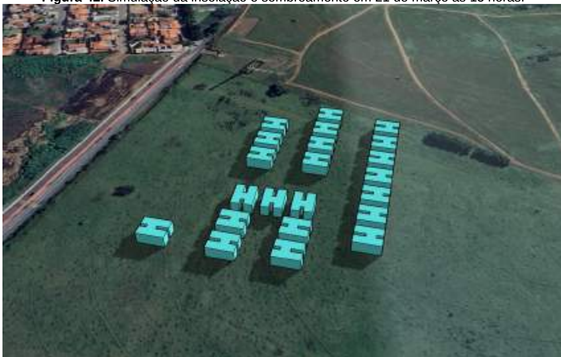
Figura 43. Simulação da insolação e sombreamento em 21 de junho às 09 horas.
