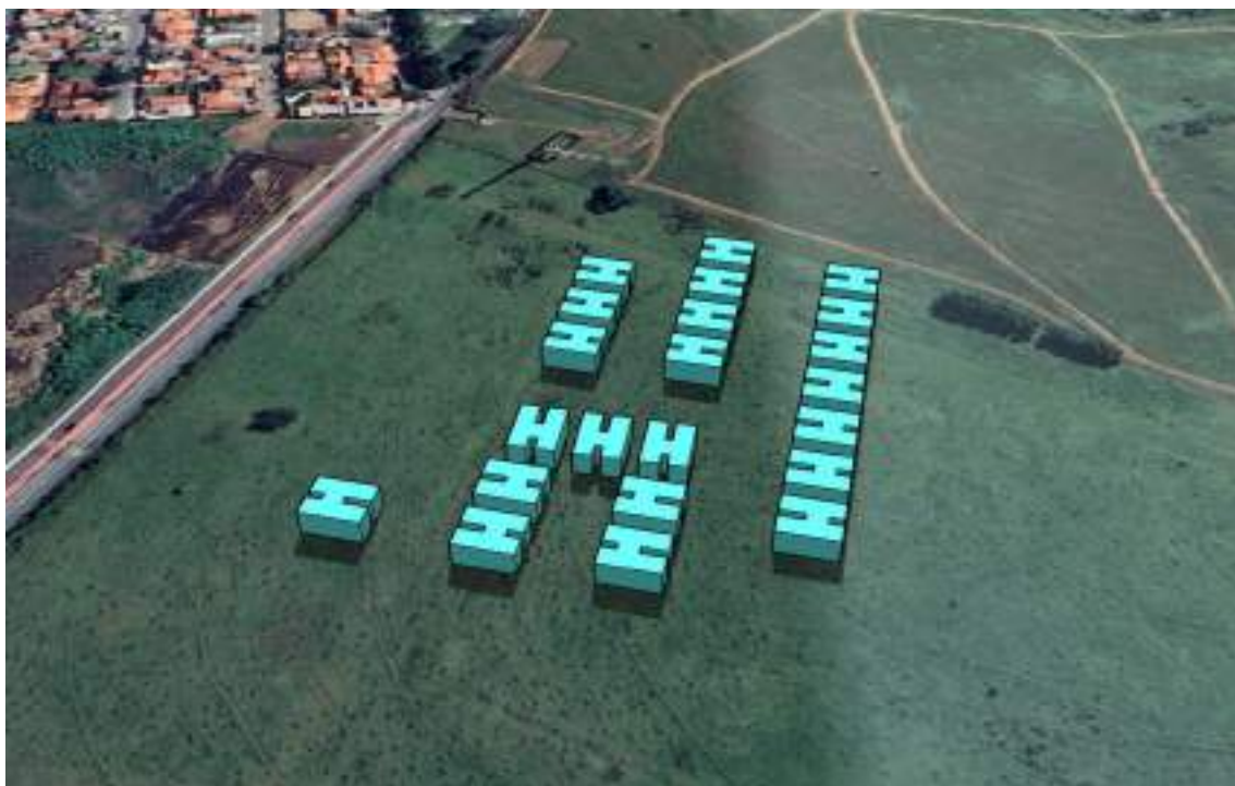
Figura 44. Simulação da insolação e sombreamento em 21 de junho às 12 horas.
