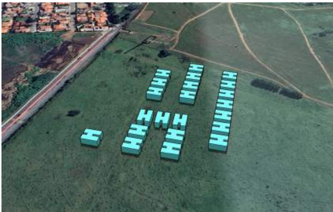
Figura 50. Simulação da insolação e sombreamento em 21 de dezembro às 12 horas.
