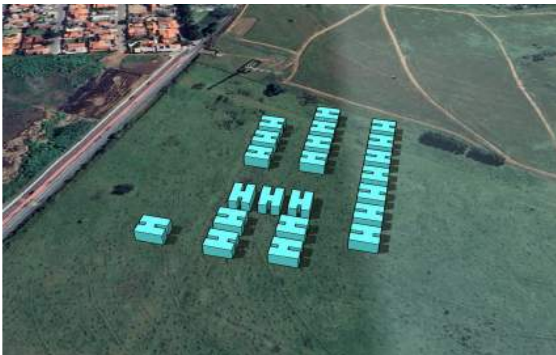
Figura 51. Simulação da insolação e sombreamento em 21 de dezembro às 15 horas.
