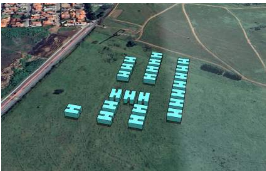
Figura 41. Simulação da insolação e sombreamento em 21 de março às 12 horas.
