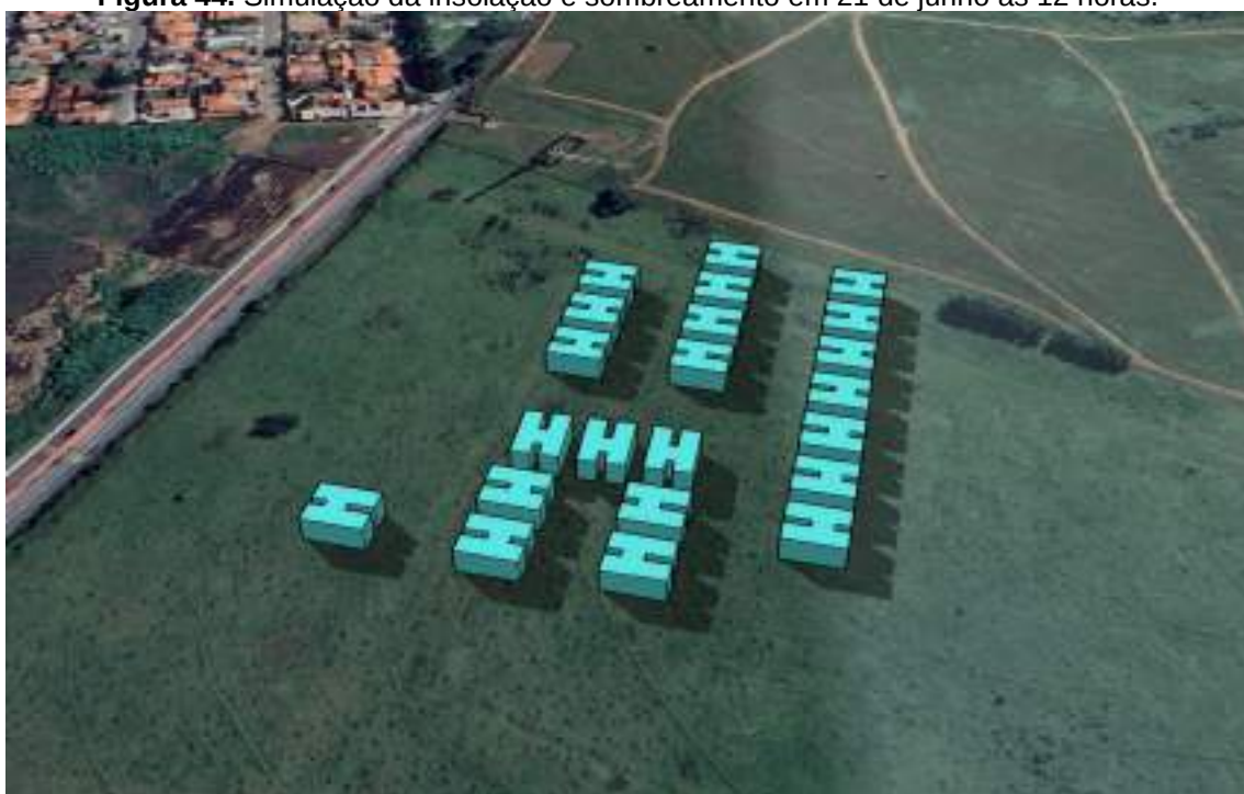
Figura 45. Simulação da insolação e sombreamento em 21 de junho às 15 horas
