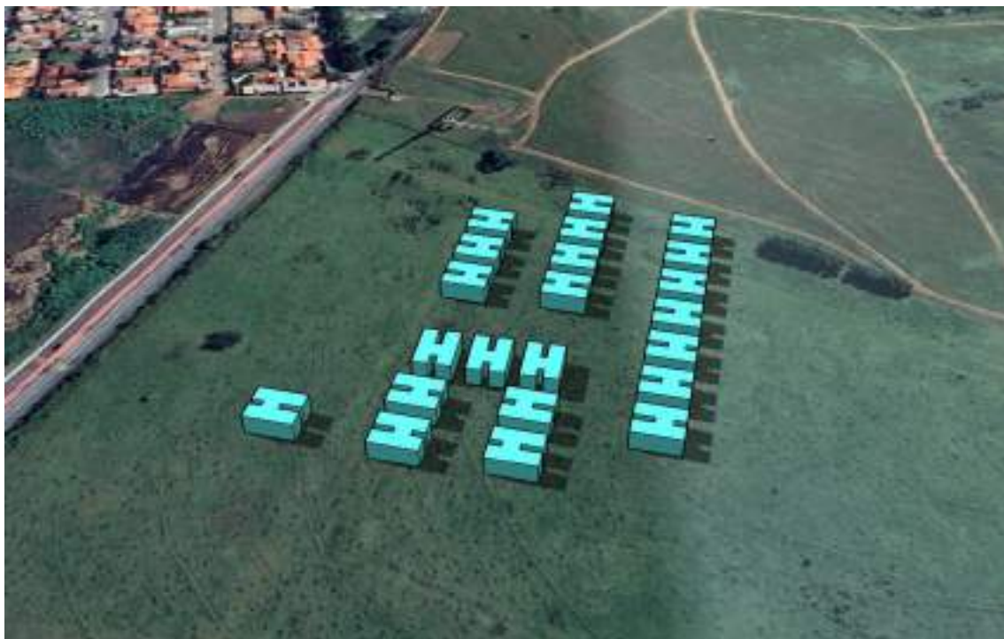
Figura 48. Simulação da insolação e sombreamento em 21 de setembro às 15 horas.
