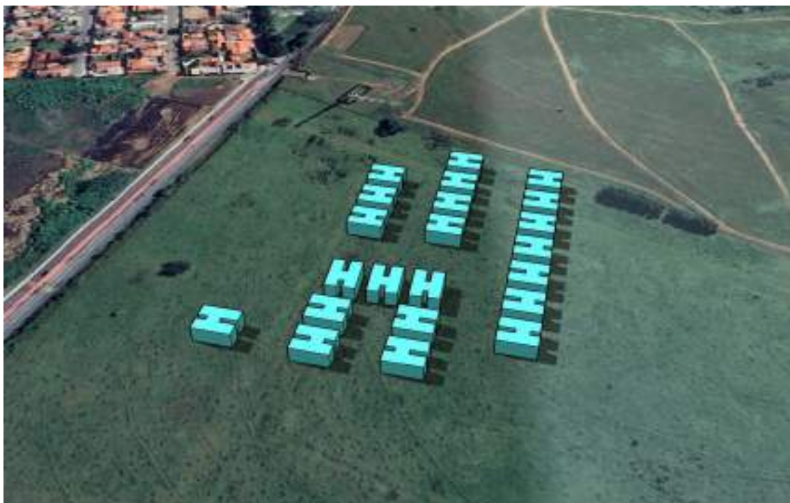
Figura 42. Simulação da insolação e sombreamento em 21 de março às 15 horas.
