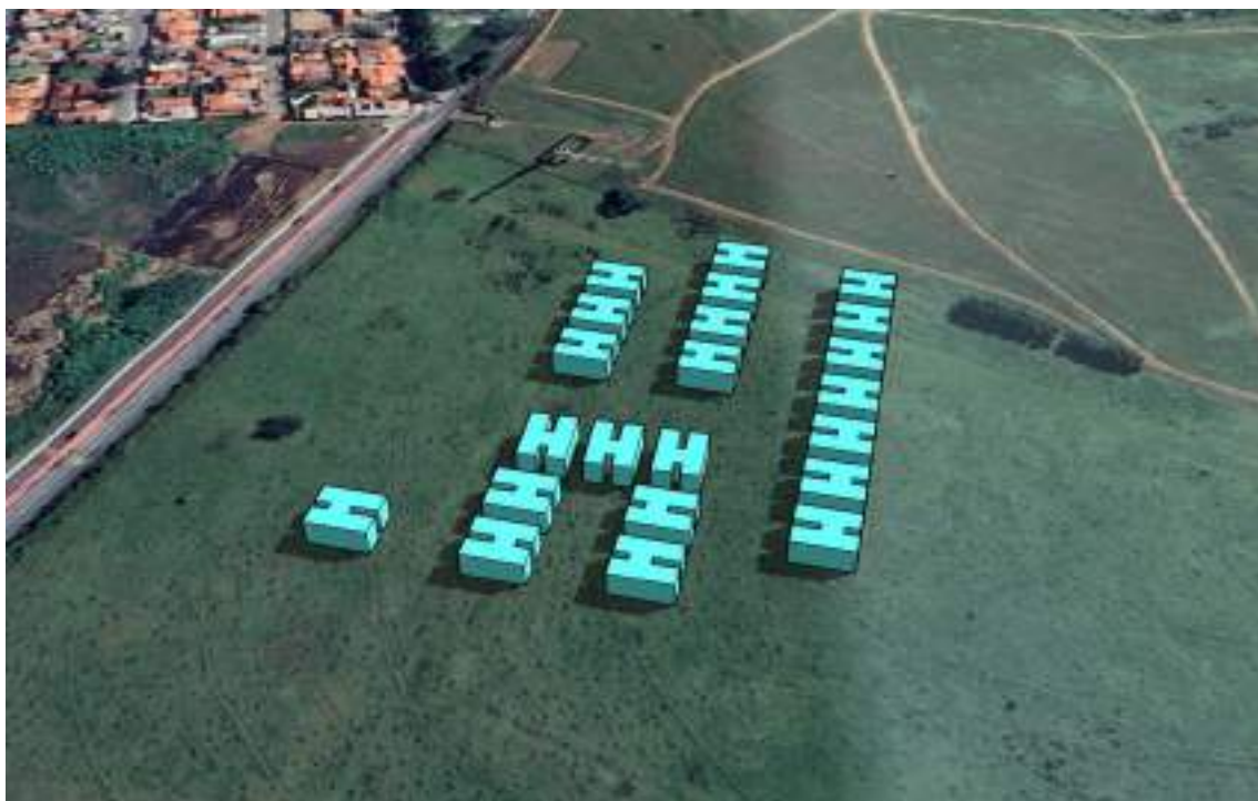
Figura 46. Simulação da insolação e sombreamento em 21 de setembro às 09 horas.
