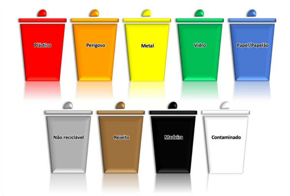
Padrão de cores para contenedores de resíduos a serem utilizados na obra.
