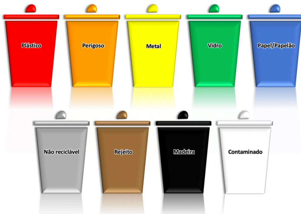
*Figura 22 - Padrão de cores para contenedores de resíduos a serem utilizados na obra.*
