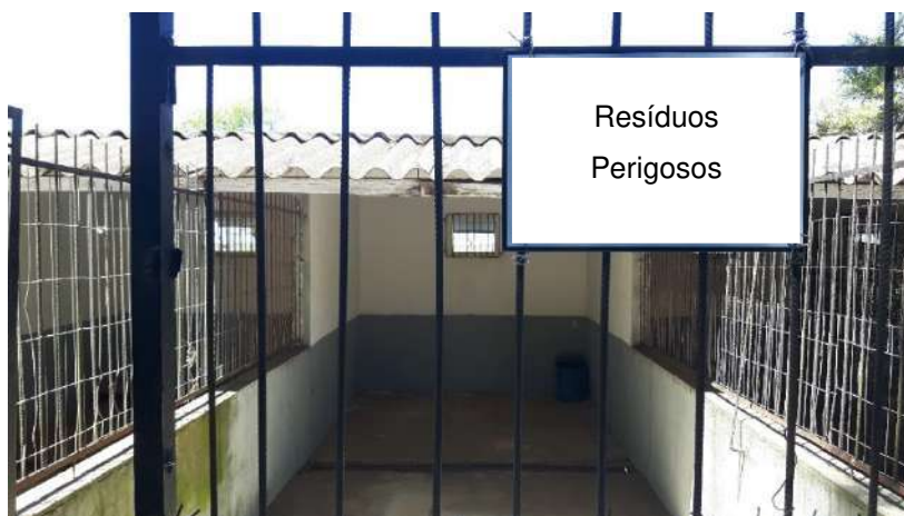
FIGURA 9: Exemplo de baias de resíduo químico/contaminado. Deve ser alocada em local coberto e impermeabilizado.
