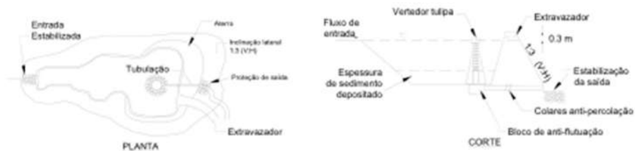
Figura 35 - Bacia de retenção
