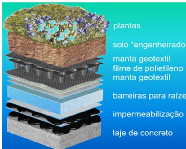
Figura 288. Esquema construtivo de telhado verde (telhado vivo)
