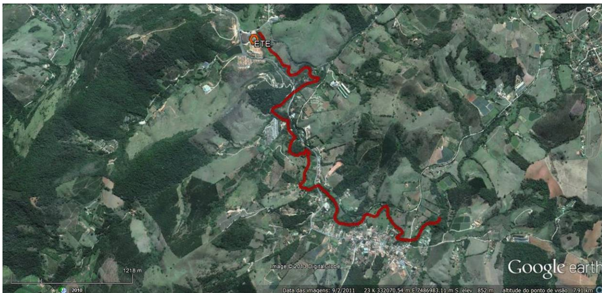
Figura 194. Traçado do emissário a ser implantado no Distrito de Mostardas
