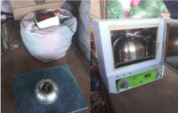
Figura 10 - Amostra de 2L de resíduos sendo pesada e posteriormente inserida em estufa que aquecerá até 105°C.
