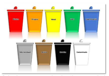
Figura 5 - Padrão de cores para contenedores de resíduos a serem utilizados na obra.
