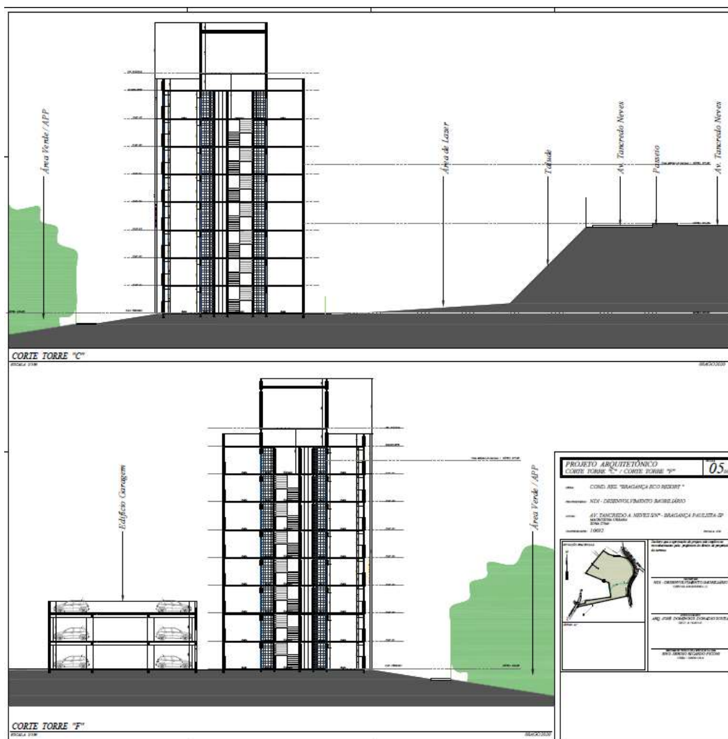
Figura 25: Corte Esquemático, conforme Projeto Arquitetônico Fls. 05 e 06 - Corte Torres "B", "C" e "F" (Anexo 07), demonstrando que os edifícios possuem gabarito de altura máximo na cota 885,40, devido a acréscimo de 3 pavimentos de 2,80 m de altura sobre a cota 877 (cota mais alta da testada do terreno).
