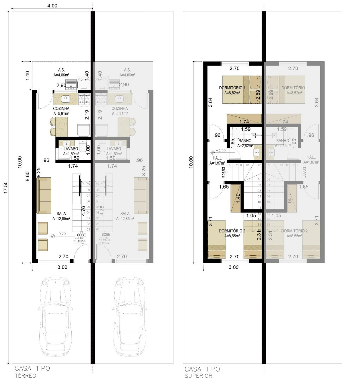
Figura 2: Projeto Unidade Tipo Fonte: Arco Arquitetura 2021
