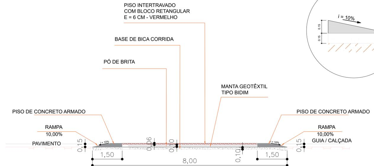
CORTE - BB - ESQUEMA DE TRAVAMENTO E RAMPA
