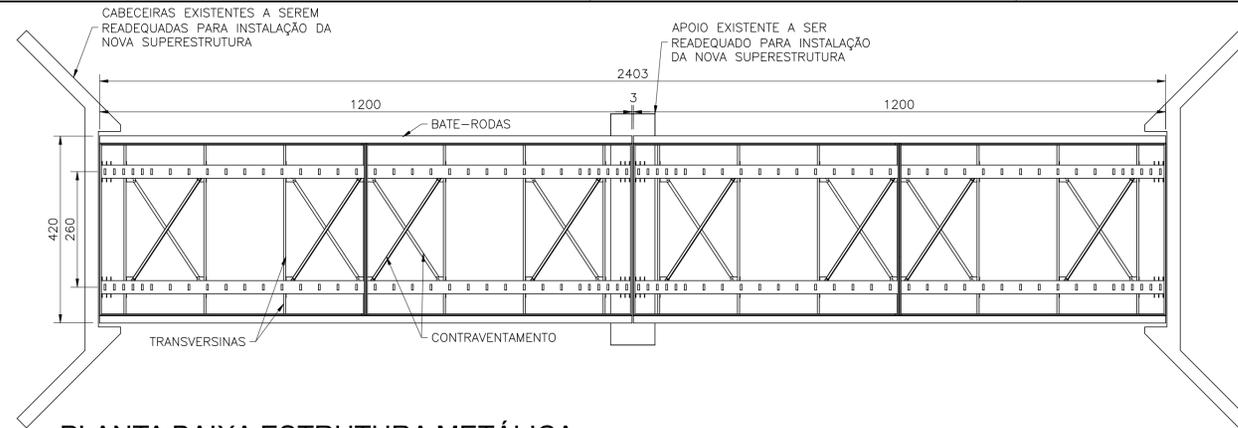
**PLANTA BAIXA ESTRUTURA METÁLICA**
