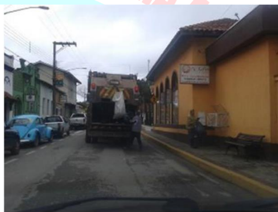
Caminhão compactador utilizado na coleta convencional dos resíduos sólidos urbanos na área central do município.
