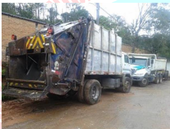
Caminhão compactador utilizado na coleta convencional dos resíduos sólidos urbanos na área central do município.
