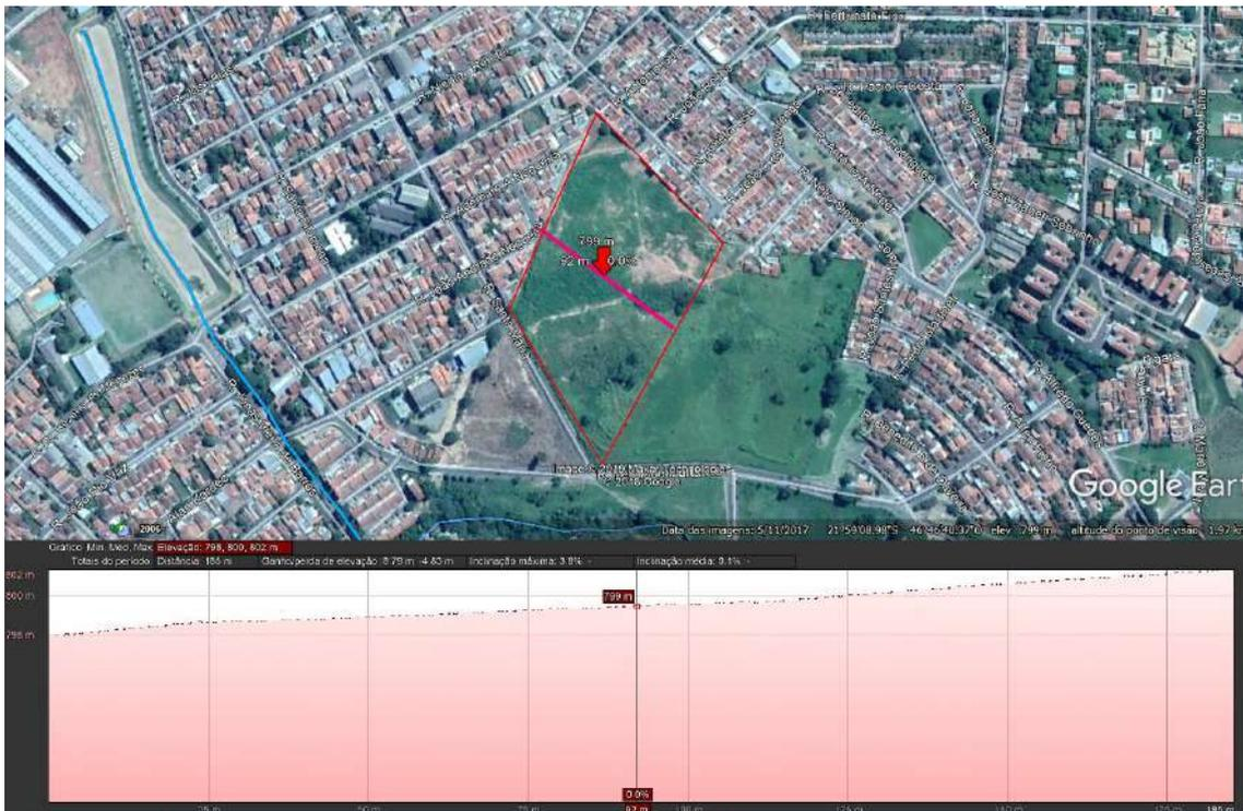
Figura 09 – Perfil topográfico da gleba no sentido SE-NW (acompanhando as curvas de nível). Declividade média de 0,1% e máxima de 3,8%. Fonte: Google Earth.
