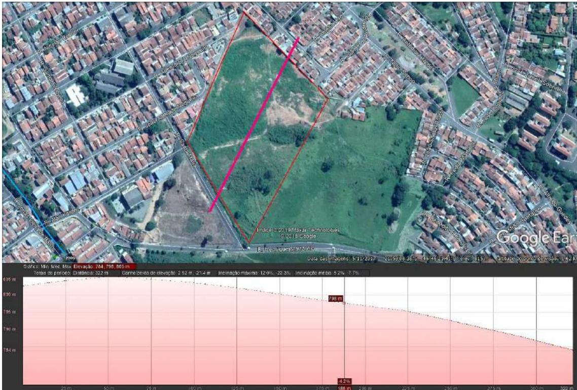
Figura 08 – Perfil topográfico da gleba no sentido NE-SW. Declividade média ente 5,2 e 7,7% e declividade máxima de 12,0%. Fonte: Google Earth.
