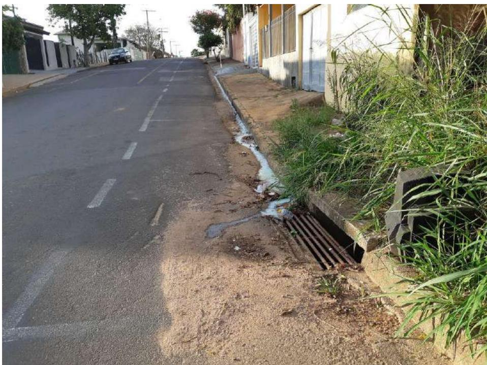
**Foto 06** – Vista do sistema de drenagem existente na Rua Santa Maria. Notar que frente da gleba não possui passeio com calçamento, impedindo a circulação de pedestres. Isso será corrigido pelo empreendimento melhorando as condições de acessibilidade. Fonte: Flektor Urbanismo.
