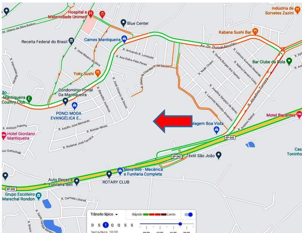
Figura 56 – Situação típica – terça-feira – 18:00hs. A situação apontada pelo Google Maps não se confirmou nas medições no local, onde o tráfego mostrou-se sempre livre, com volumes abaixo de 360-V/h ou 6V/min.
