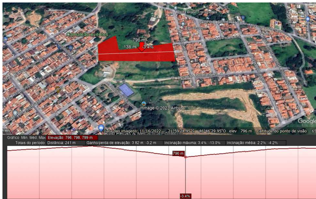
Figura 6 - Perfil topográfico do condomínio - Leste/Oeste
