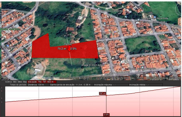
Figura 7 - Perfil topográfico do condomínio - Norte/Sul
