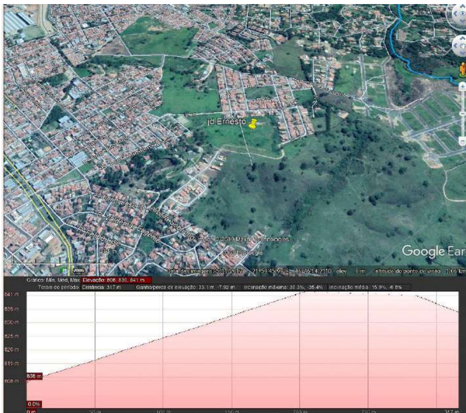
Figura 08 – Perfil topográfico da gleba no sentido norte-sul. Declividade média de 15,9%. Fonte: Google Earth.
