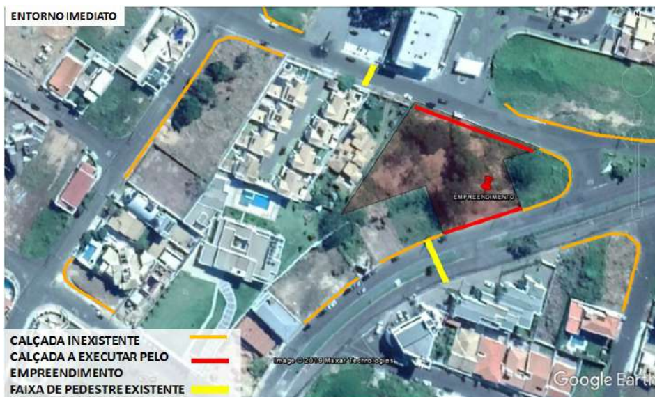
Figura 47: Condição de passeios e travessias. Fonte: Google Earth Pró, anotações do autor.
