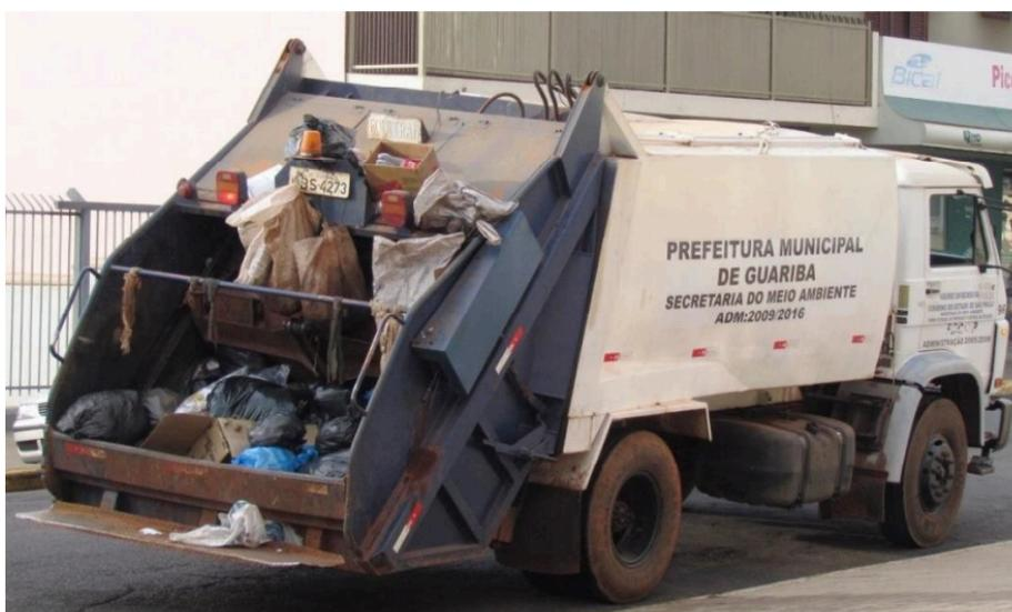
**Figura 11 – Caminhões coletores utilizados na coleta convencional de resíduos domésticos. Fonte (PIGRS, 2014).**
