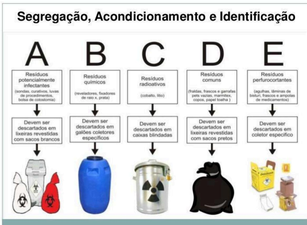
Figura 25. Segregação, Acondicionamento e Identificação de resíduos de saúde.
