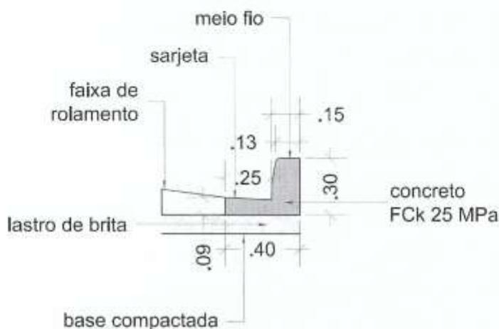
Os sarjetões deverão ser executados sobre terreno devidamente regularizado e compactado. O concreto a ser empregado na confecção dos mesmos deverá ter resistência à compressão mínima de 25 MPa. Deverão estar locados nos pontos necessários para continuidade da drenagem promovida pelas guias e sarjetas extrudadas.
